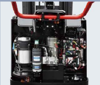
Il cofano motore può essere aperto completamente: tutte le componenti ed i pezzi risultano visibili al primo sguardo, aspetto molto utile per la manutenzione dell'intera macchina
