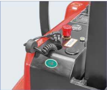
Caricabatterie incorporato e batteria al gel esente da manutenzione adottata per garantire un comodo utilizzo.
